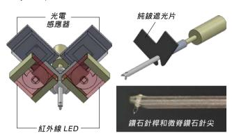
脊(micro ridge)鑽石針尖的唱針之有效質量實在低得驚 人。唱頭的內部接線亦比上一代粗身1.6倍以降低阻抗, 唱頭殼則仍用超級杜拉鋁以CNC車製。
